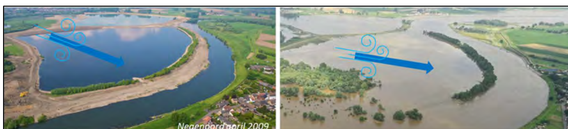
Figuur 3.14 Voorbeeld van functioneel bos; aangeplante zwarte populierenbosgordel in 2009 helpt Obbicht (NL) mee beschermen tegen sterke golfwerking vanuit het westen bij hoge waterstanden (links), dezelfde situatie bij het hoogwater in juli 2021 (rechts).
