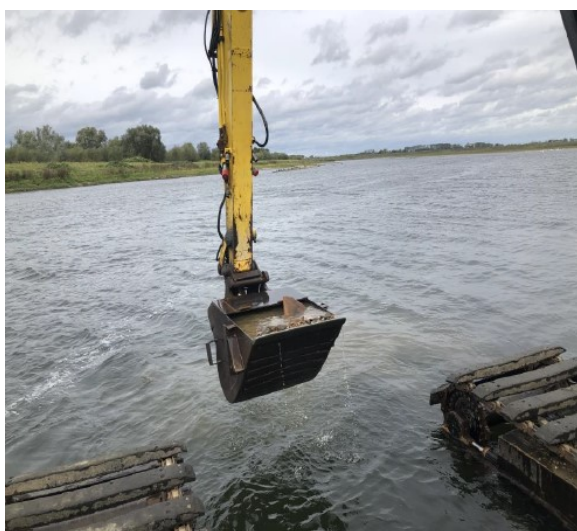
Fig. 3. Bemonstering van de Maas met de amfibische kraan (BK Ingenieurs, 2023).
